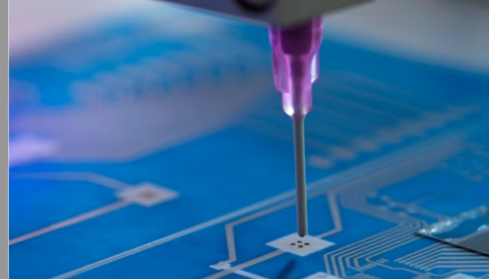
Detailansicht eines Folien-systems zur Temperaturmessung während der Prozessierung
